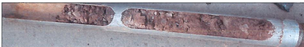
Foto 5: Erkundungsstelle 1 – Bohrgut Kleinrammbohrung
