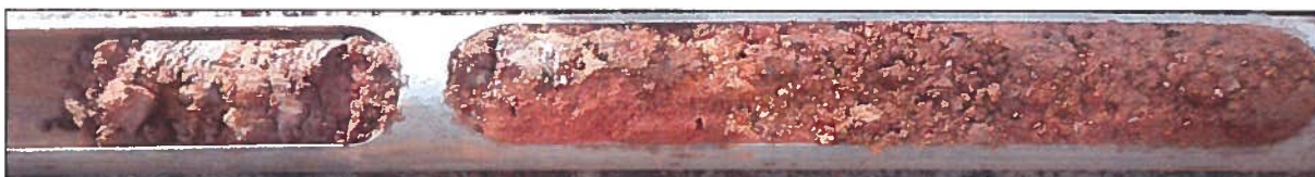
Foto 10: Erkundungsstelle 2 – Bohrgut Kleinrammbohrung
