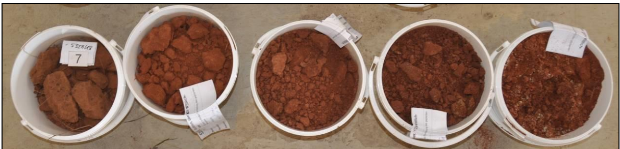
Foto 21: Erkundungsstelle 7 – Aushub nach Aufschlusstiefe
