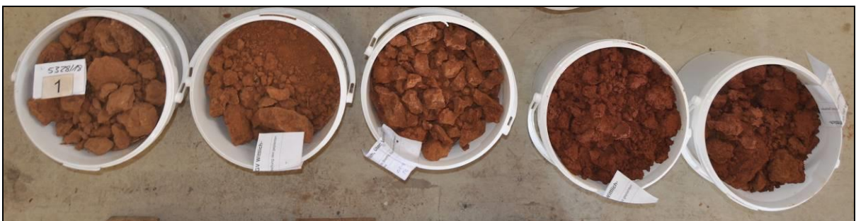
Foto 4: Erkundungsstelle 1 – Aushub nach Aufschlusstiefe
