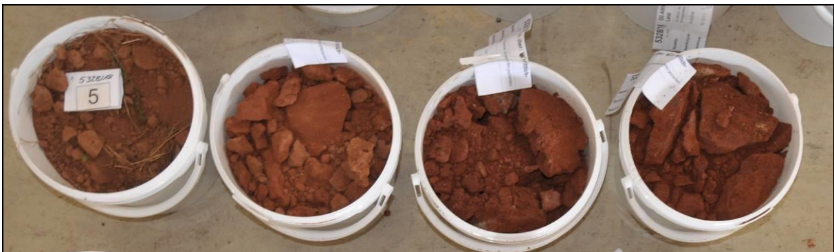
Foto 13: Erkundungsstelle 5 – Aushub nach Aufschlusstiefe
