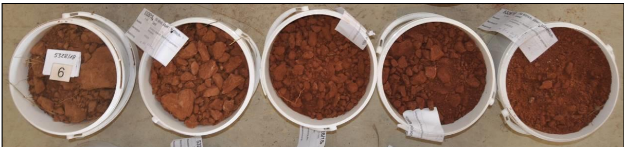
Foto 17: Erkundungsstelle 6 – Aushub nach Aufschlusstiefe
