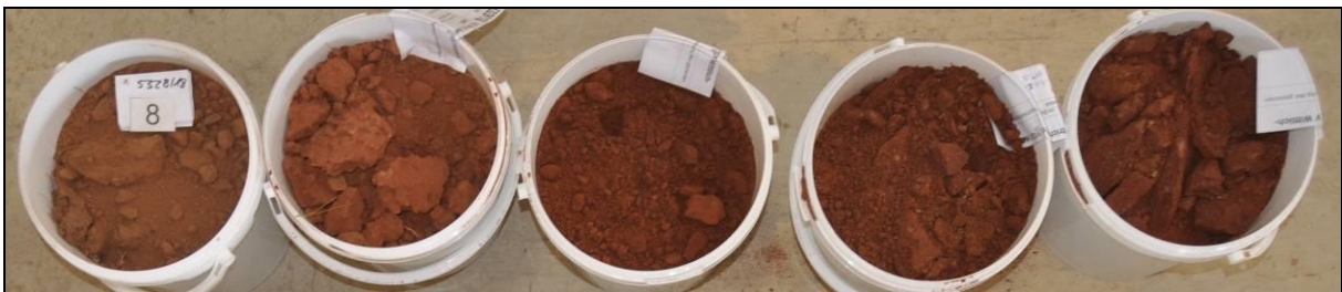
Foto 25: Erkundungsstelle 8 – Aushub nach Aufschlusstiefe
