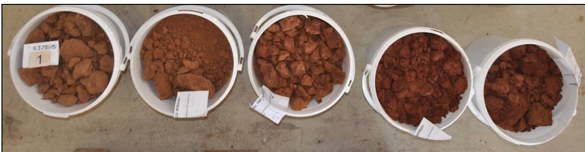
Foto 4: Erkundungsstelle 1 – Aushub nach Aufschlusstiefe
